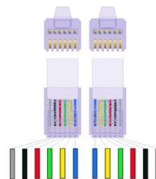
Figuur 5 Fiches gekruiste RJ12-kabel
